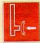
Пожарный сухотрубный стояк
