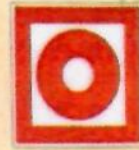
Кнопка включения установок (систем) пожарной автоматики
