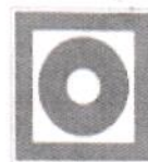
Кнопка включения установок (систем) пожарной автоматики
